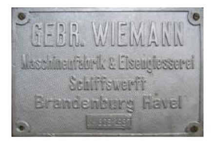
Obwohl die Werftschilder oberflächlich betrachtet gleich aussehen, so gibt es doch Unterschiede bei näherer Betrachtung. Der gravierendste Unterschied ist das Hinzufügen der Baunummer. So scheint 1925 der Wechsel erfolgt zu sein.
